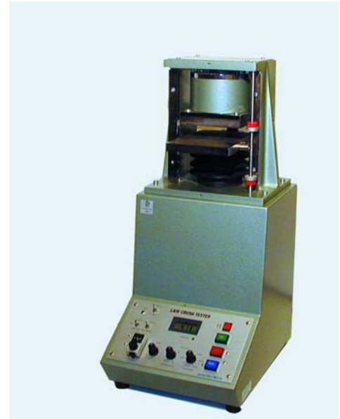
Figuur 18: Lorentzen & Wettre ECT - tester (ref.: www.lorentzen-wettre.com )
